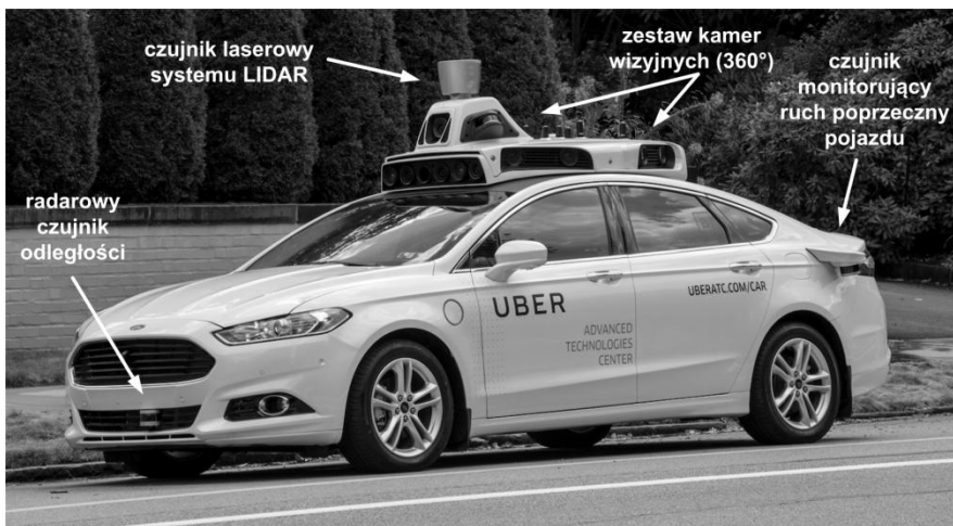
Rysunek 2. Zestaw sensorów zamontowanych na samochodzie autonomicznym (opracowanie własne, zdjęcie: uber.com)
